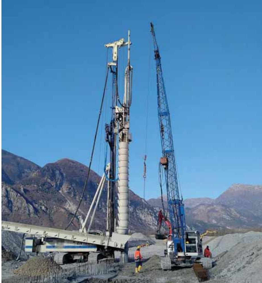
**Una Enteco E9080 DR attrezzata con un dispositivo brevettato in grado di convogliare il materiale di risulta su un nastro trasportatore e scaricare a lato della perforatrice il terreno scavato**
